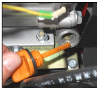
Figura 19: Varilla indicadora del nivel de aceite
